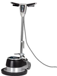
El FM Floor Maintainer es una máquina para el cuidado de los pisos con cable disponible en dos anchos: 17 pulgadas (43 cm) y 20 pulgadas (51 cm). El sistema de accionamiento planetario doble utiliza un rodamiento de agujas de precisión, y un robusto motor de 1 CV con un factor de servicio de 1,25 proporciona potencia adicional para el esmerilado, el lijado y la limpieza de alfombras, así como para el pulido y fregado.
