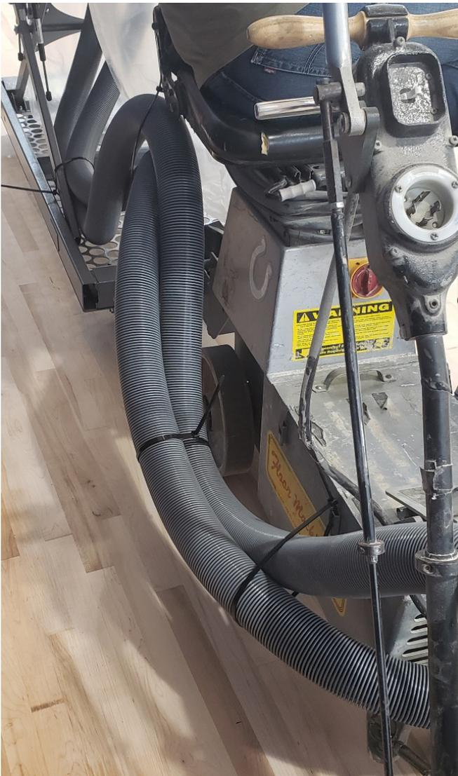
10. Acheminez les deux câbles d'alimentation à travers le mousqueton à l'extrémité de la tige de support de cordon rouge. Fixez les câbles avec du ruban adhésif ou des attaches à glissière les uns aux autres et à la tige de support.
