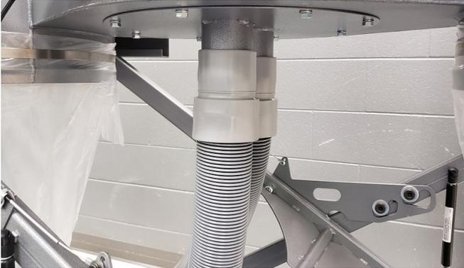
9. Fixez les deux tuyaux de collecte de poussière au Gym Vac et au pilote. Fixez de manière à empêcher les flexibles de traîner sur le sol et d'obstruer l'accès de l'opérateur au pilote ou à la vue. Les cordons élastiques fournis avec le Gym Vac peuvent être utilisés pour fixer les tuyaux.
