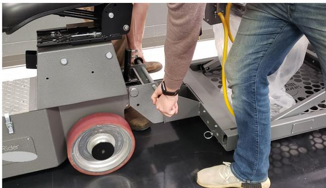
**Remarque :** Dans le cas où le récepteur sur le pilote n'est pas perpendiculaire au pilote, le Gym Vac peut se connecter au pilote à un angle. Cela aura pour conséquence que le Gym Vac s'étendra davantage vers la gauche ou la droite du pilote à un angle. Ceci peut être corrigé avec ce qui suit :
