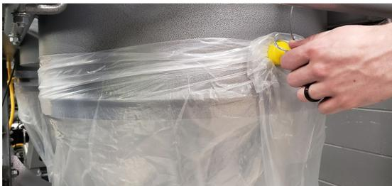
5. Enroulez un sac poubelle autour de chaque sortie d'évacuation du boîtier du ventilateur. Placez le sac à environ 7,62 cm à 10,16 cm (3 à 4 po) au-dessus du bas de la sortie d'évacuation. Tirez fermement le sac autour de la sortie ronde et maintenez-le en place avec l'aimant rond attaché. Répétez le processus pour les deux sacs.
